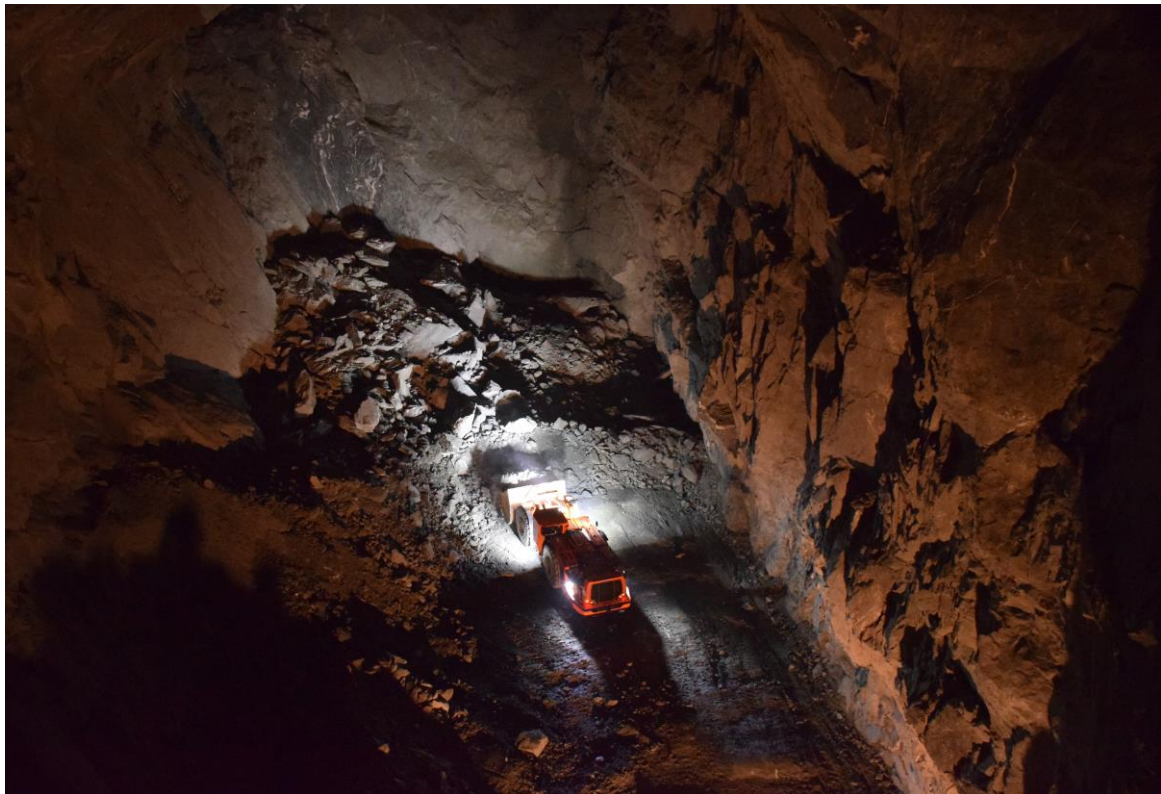
Funkferngesteuerter Fahrlader im Abbau
